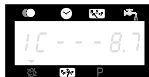
Per le valvole con clorinatori, La lettera C indica il suo funzionamento.
