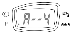
Impostazione calendario (numero massimo di giorni tra due rigenerazioni) Esempio: rigenerazione ogni 4 giorni (solo in modalità cronometrica, regolazione obbligatoria)
