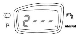
La valvola si sposta sul ciclo 2 Il numero e il diodo lampeggiano
